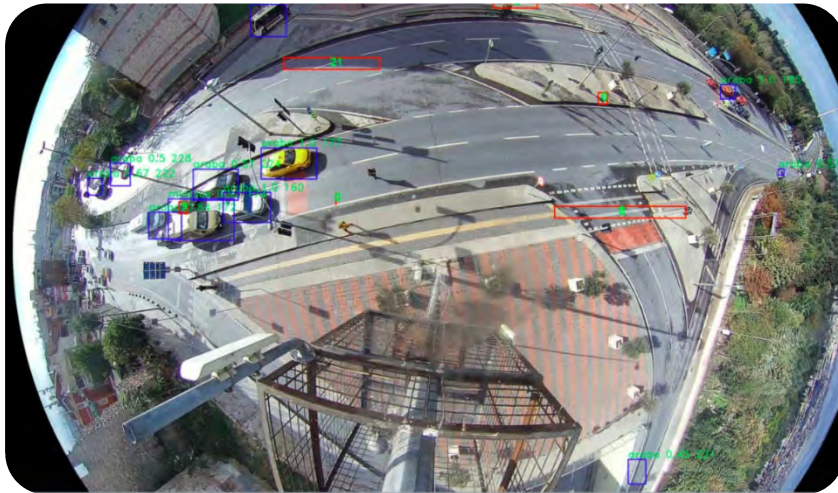
Balık Gözü ile Kavşak Yönetimi için Yapay Zekâ Tabanlı Video Detektör Kamera Görüntüsü
